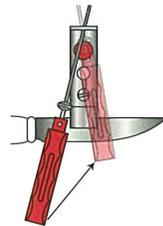
**Choix des pierres d'aiguisage:** Pour réaffûter des lames très émoussées, débiter avec la pierre au grain le plus gros. Utiliser successivement toutes les pierres en choisissant chaque fois un grain de plus en plus fin. Dans le cas de lames légèrement émoussées, débiter plutôt avec les pierres à grain moyen ou fin. Les pierres au grain le plus fin produisent un tranchant lisse et poli.
