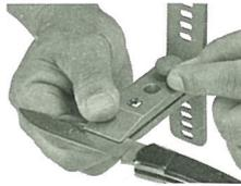
**PRO TIP:** Für beste Resultate sollte die Spalte auf der Rückseite der Klammer gleich oder größer als die Spalte bei den vorderen Zacken der Klammer sein. Ungefähr 5/8" (1,6 cm) der Klinge sollte vom Ende der Klammer freistehend sein. Für Klingen unter 1/2" (1,25 cm) Breite, oder um einen 17° Winkel an den meisten Klingen zu erreichen: die beiliegende Flachschaube benutzen anstatt der vorderen Daumenschraube.
