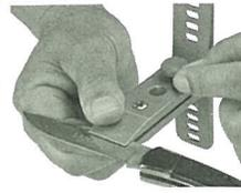
**CONSEIL DE PRO:** Pour obtenir de meilleurs résultats, l'écart à l'arrière de l'étau doit être égal ou supérieur à l'écart à proximité des mâchoires à l'avant de l'étau. Environ 5/8" (1,6 cm) po de la lame doit être exposée au bout de l'étau. Dans la cas de lames de moins de 1/2" (1,25 cm) po de largeur, ou pour aiguiser à un angle de 17° sur la plupart des lames, remplacer la vis de serrage avant par la vis plate fournie.
