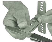
**CONSEJO PROFESIONAL:** Para obtener los mejores resultados, la brecha en la parte trasera del sujetador debe ser igual o mayor que la brecha en la boca del sujetador. La hoja del cuchillo debe sobresalir aproximadamente 1,6 cm (5/8 pulgada) del extremo del sujetador. Para hojas menores de 1,25 cm (1/2 pulgada) de ancho o para lograr un ángulo de 17° en la mayoría de las hojas, haga lo siguiente: en lugar del tornillo frontal para ajuste manual use el tornillo de cabeza plana suministrado.
