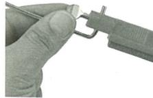
Sobre una superficie llana, compruebe que la varilla esté recta y alineada con respecto a la piedra de afilar. Asegúrese de que tanto la varilla como la piedra de afilar tocan la superficie llana en toda su extensión. Si la varilla no está nivelada con respecto a la piedra de afilar, dóblela para que se alinee **presionándola levemente con los dedos.**
